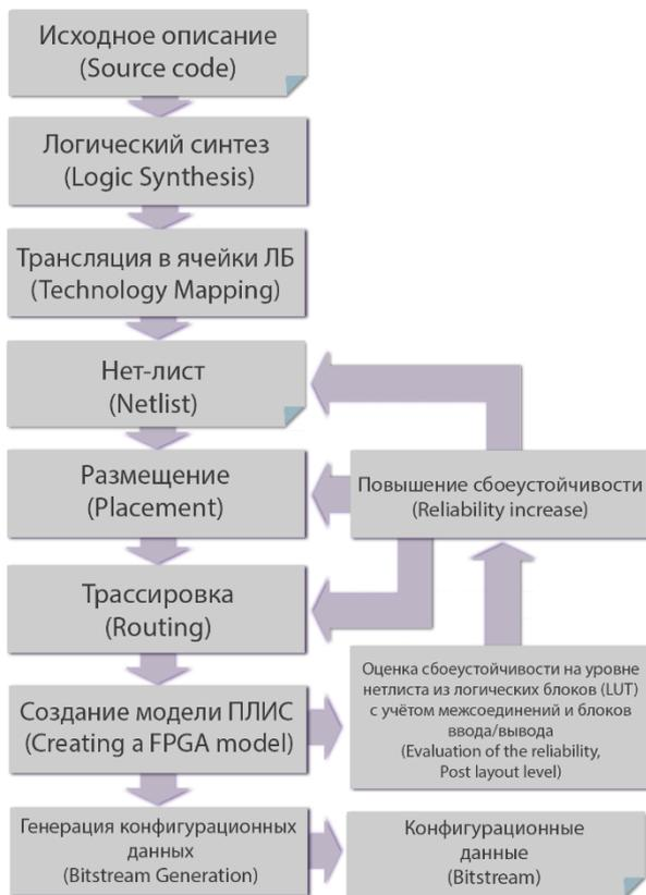
Рис. 2. Маршрут проектирования сбоеустойчивых схем ПЛИС
